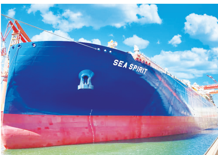
图为正在建造中的17.5万立方米LNG运输船。中国船舶大连造船供图
